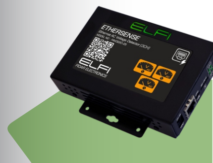
دکتور ولتاژ متناوب سه کانال مدل: FAV۰۲۲۰-۲۵ محدوده سنجش ۰-۲۲۰ ولت قابلیت تشخیص سریع قطعی برق شناسایی وضعیت سه کانال به صورت همزمان
