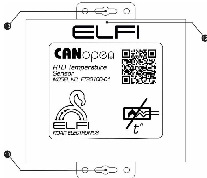
شکل ۳: نمای روبه روی Node دمای PT100
