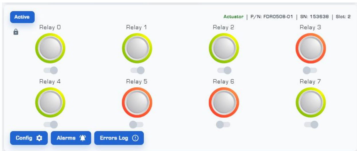
شکل ۴: نمایی از صفحه‌ی مربوط به نمایش کارت رله‌ی خروجی در رابط کاربری دستگاه
