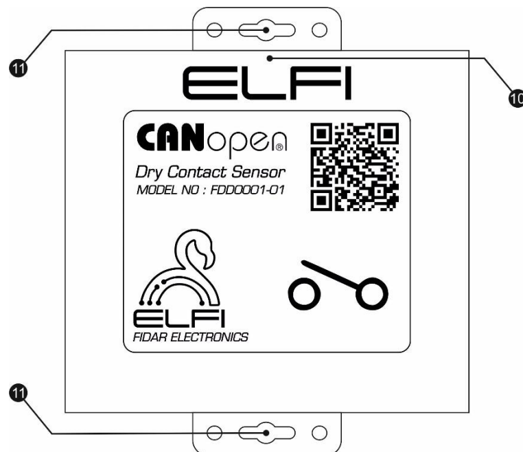
شکل ۳: نمای روبه روی Node کنتاكت خشک تک کانال
